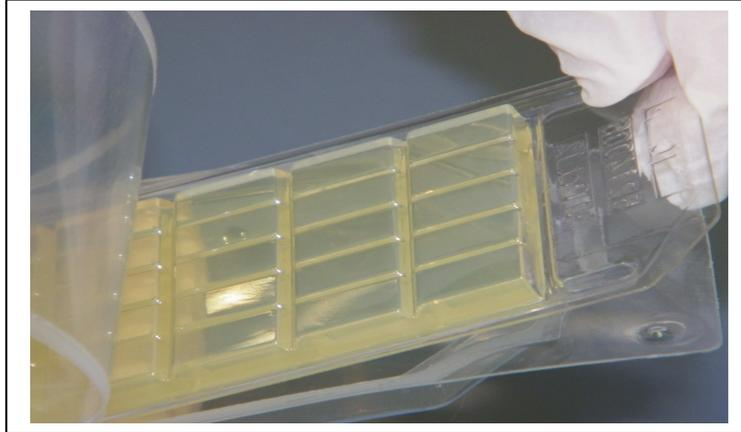
**Steriles Entnehmen** des Contact slide aus der Verpackung.
