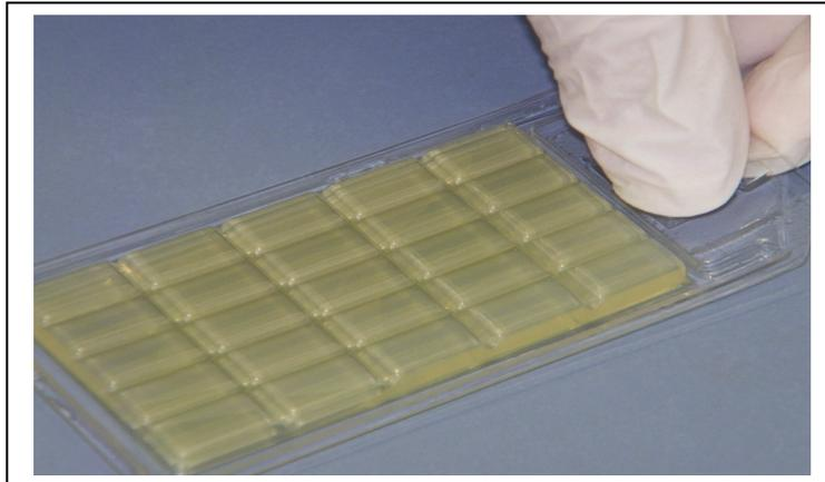
Contact slide mit **leichtem Druck** auf die zu prüfende Oberfläche auflegen.
